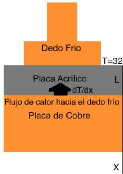
Figura 5-6. Modelo simplificado del sistema placa de cobre-placa de acrílico y dedo frío.
