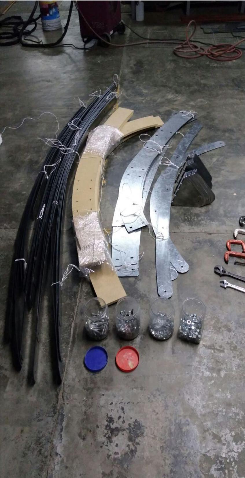
[Figura 4.9] Piezas del cascarón desarmado después del ensamble de prueba en el FabLab. De izquierda a derecha: barras cma, piezas de la primera capa del anillo de flexión en MDF, piezas de la segunda capa del anillo a flexión en acero, barras del arco de acceso, piezas dobladas, llaves y prensas. Abajo: tornillos y tuercas para las uniones. El peso total de las piezas es de 152 kg.
