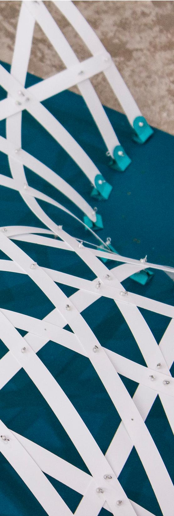
[Figura 1.1] Primer prototipo físico del cascarón reticular geodésico de flexión activa. Realizado en escala 1:10 con barras de estireno laminado de 0.45mm de espesor. Realizado durante práctica profesional en el laboratorio de estructuras de la Facultad de Arquitectura de la UNAM con ayuda de Miguel Barón.
