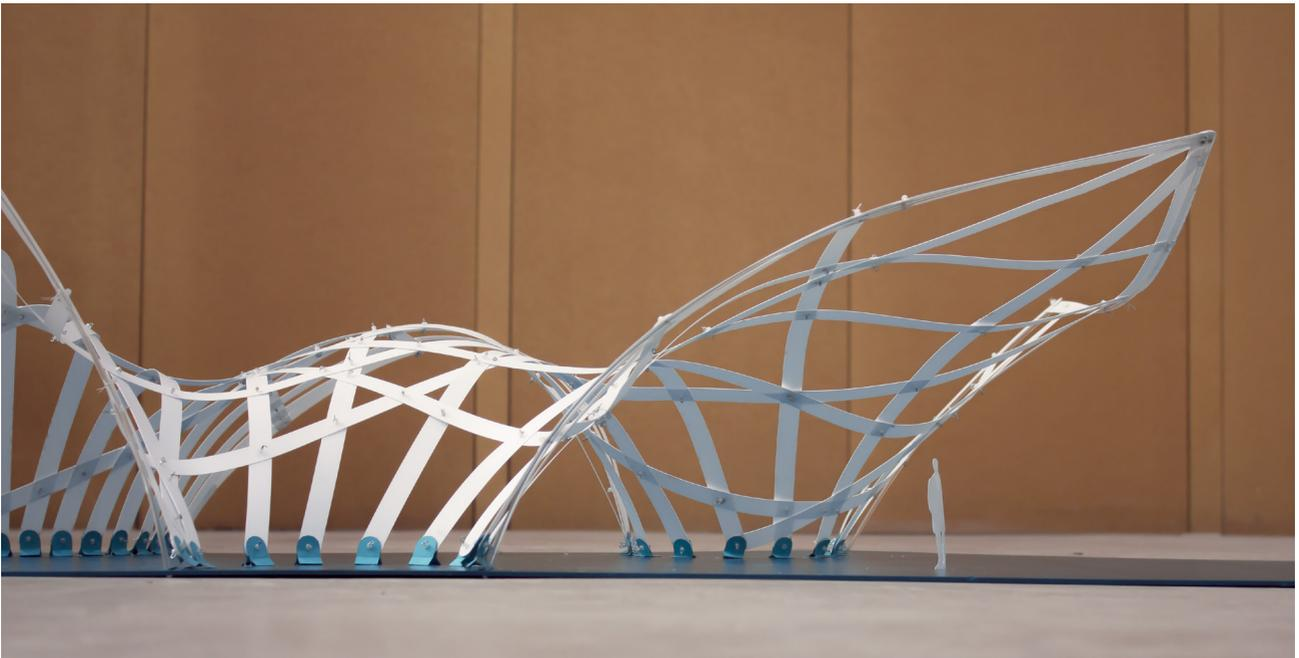
[Figura 1.16] Primer prototipo a escala de CRGFA realizada en el Laboratorio de Estructuras de la F.A. UNAM. Las barras son de estireno y las uniones son de alambre de acero con cuentas de vidrio. Video del proceso disponible en: [https://www.youtube.com/watch?v=-B90gAMeazg&ab\\_channel=erikmolina](https://www.youtube.com/watch?v=-B90gAMeazg&ab_channel=erikmolina)
