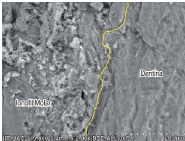
Figura 7. Ionofil Molar (VOCO) ® Buena integración de la dentina-restauración (15).
