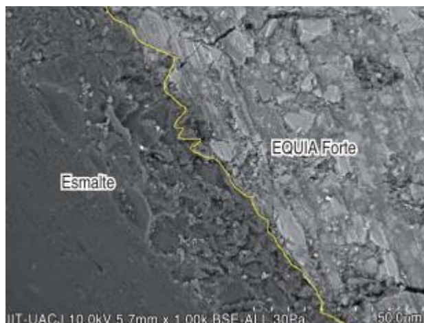
Figura 10. EQUIA Forte (GC) ® La unión a esmalte-restauración es de excelente calidad, en algunas zonas incluso se dificulta observar la transición del ionómero de vidrio al esmalte (15).
