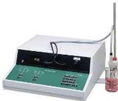
Figura 6. Espectrofotómetro de sonda Metrohm, modelo 662.
