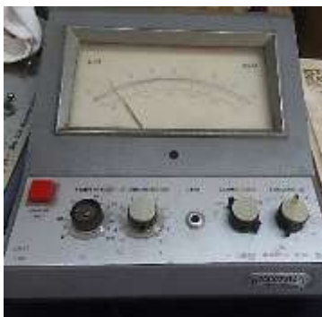
Figura 12. Milivoltímetro analógico Tacussel, modelo 2G 8N.
