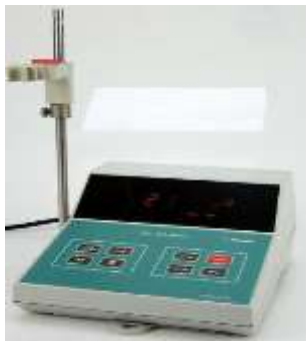
Figura 11. Potenciómetro Metrohm modelo 713 pH meter.
