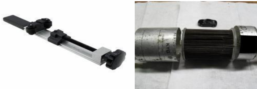
Figura 3.19. Herramienta para separación manual de filtros de aceite y combustible. Adaptado de González (2011).
