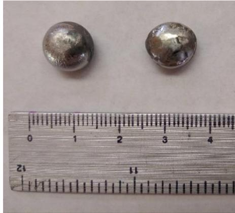
*Figura 3.2. Lingote inicial de las aleaciones  $Fe_{70}Al_{30}$  y  $Co_{74}Zr_{16}Mo_4Si_3B_3$  obtenido en horno de arco eléctrico*
