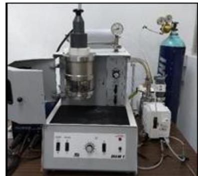
*Figura 3.1 Horno de arco eléctrico*
