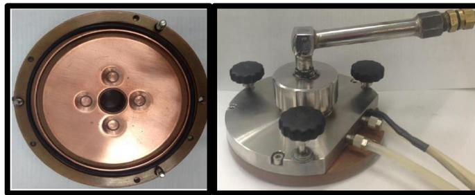
*Figura 3.4. Platina empleada para el proceso de succión en molde de Cu*
