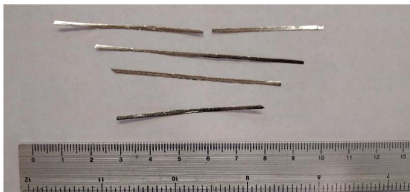
**Figura 3.7.** Cintas obtenidas de la aleación  $Co_{74}Zr_{16}Mo_4Si_3B_3$  a través de “melt-spinning”
