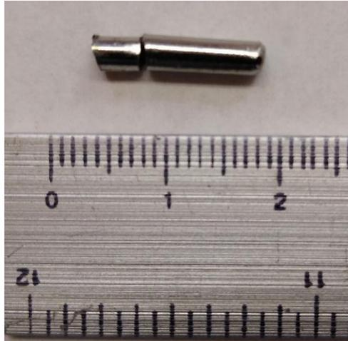
*Figura 3.3 Cilindro colado en molde de Cu perteneciente a la aleación Fe<sub>70</sub>Al<sub>30</sub>*
