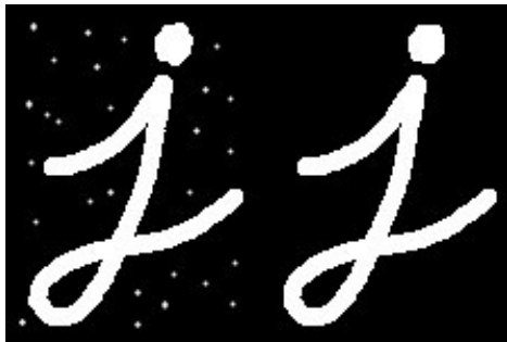
Figura 3.10: Eliminación de ruido alrededor de una figura de interés usando la erosión. Imagen tomada de: https://docs.opencv.org/3.4/d9/d61/tutorial_py_morphological_ops.html .
