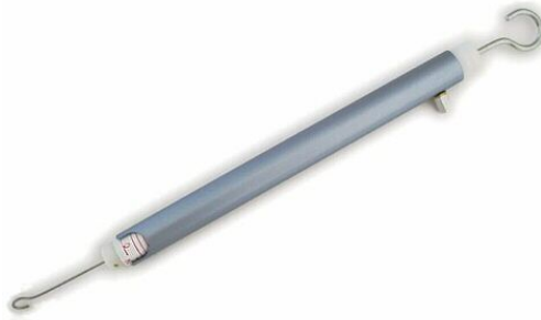
Figura 4.6: Dinamómetro de resorte utilizado para obtener la fuerza de fricción. Imagen tomada de: https://tecnoedu.com/Pasco/DinamometrosECYT.php
