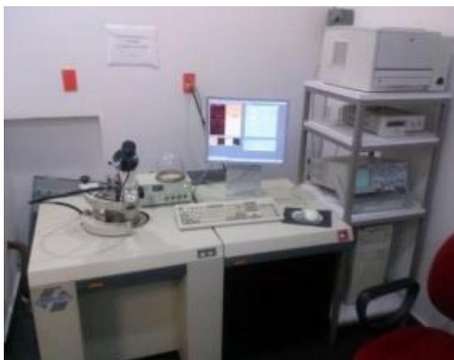
**Figura 24. Microscopio de Fuerza Atómica JEOL JSPM4210.**
