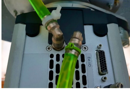
Figura 5: Conexión de las mangueras al detector.
