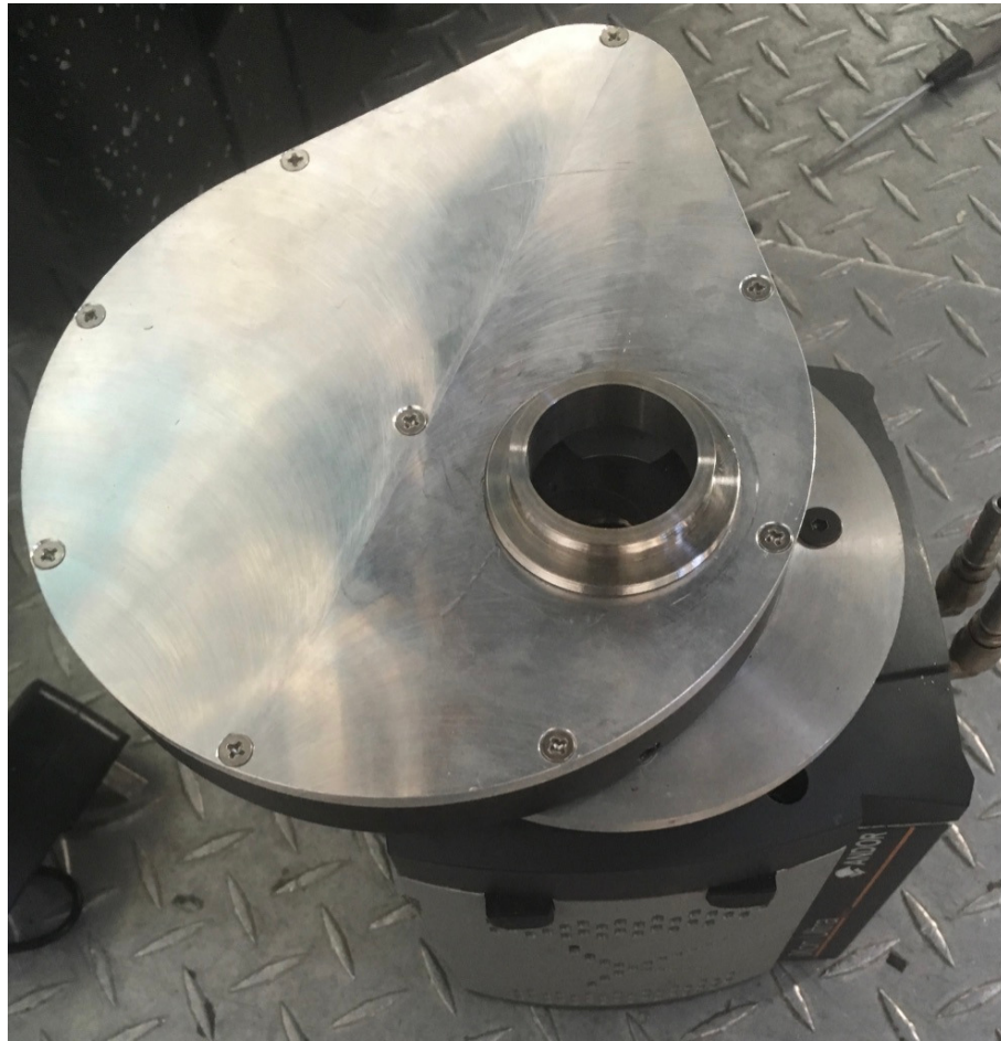
Fig. 3.8: Rueda de filtros FLI modificada para soportar el peso de la cámara.
