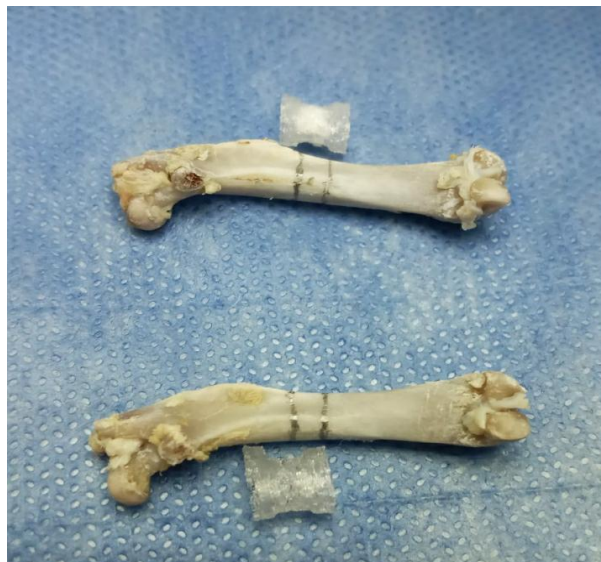
(Figura 12) Andamio de PLA y andamio híbrido de PLA y PCL junto al hueso fémur derecho.
