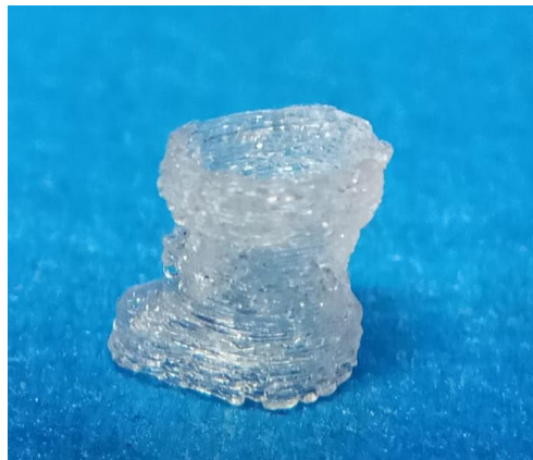
(Figura 9) Se observa un andamio e impreso 3D con filamento de PLA transparente.
