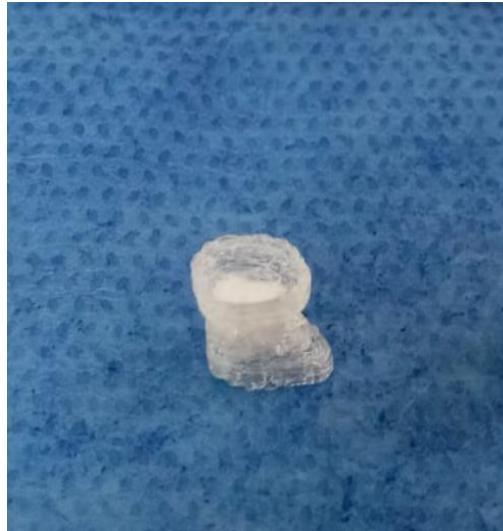
(Figura 11) Resultado de andamio híbrido de PLA y PCL
