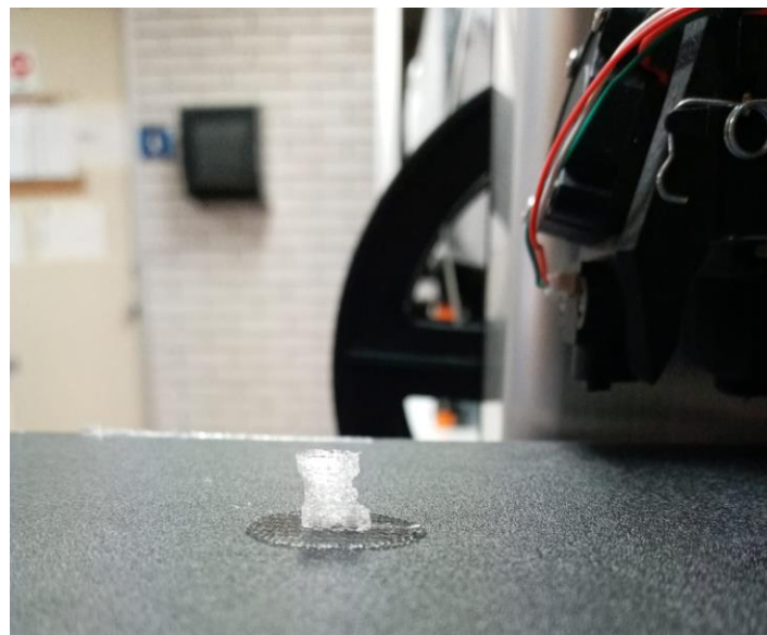
(Figura 7) Andamio impreso mediante modelado por deposición fundida del material termoplástico PLA transparente.
