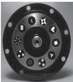
Figura 7a. Boquilla para extrusor. Nota. Adaptado de dado, por Riaz, 2012.
