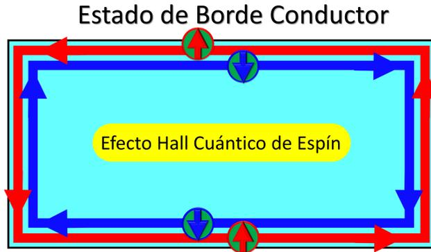
Figura 1.4: Sistema en estado de borde conductor. El material presenta transporte dependiente del espín en sus bordes, debido a que tiene estados disponibles que dependen del espín en los bordes del material.
