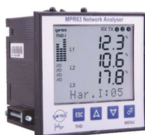
Figura 3.32: Analizador de datos utilizado para medir la potencia de entrada en la bomba de calor instrumentada.
