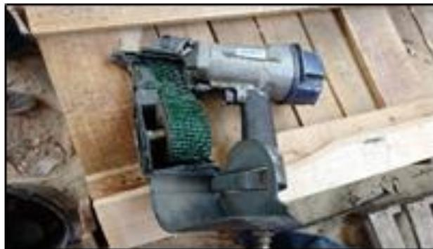
**Figura 25. Imagen de una pistola de aire, herramienta con la que unen los distintos elementos que conforman la tarima. Tomada por el autor.**
