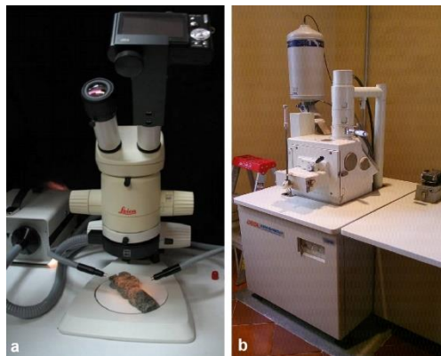
Figura 21. Microscopios empleados: estereoscópico con cámara digital acoplada (a) y electrónico de barrido (b).
