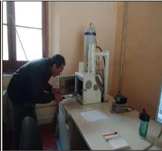
Figura 5.4.106 Introducción de una de las hachas a la precámara.
