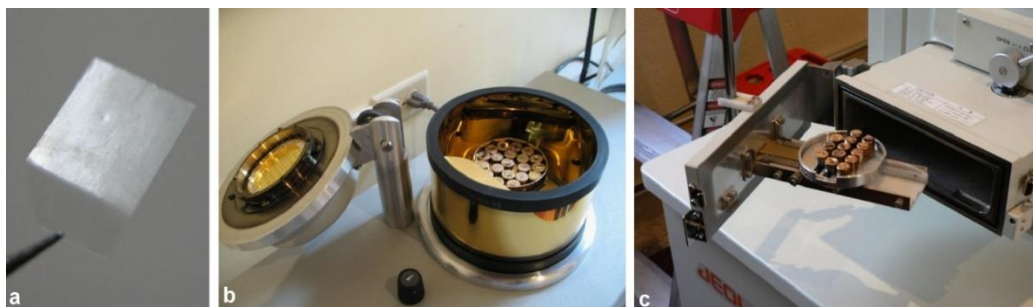
Figura 22. La realización de réplicas en polímeros (a), para ser recubiertas con iones de oro (b) y sean revisadas en la cámara de muestreo del MEB (c).
