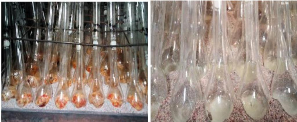
**Figura 6. a) Muestras durante la digestión triácida, b) Muestras al finalizar el proceso**
