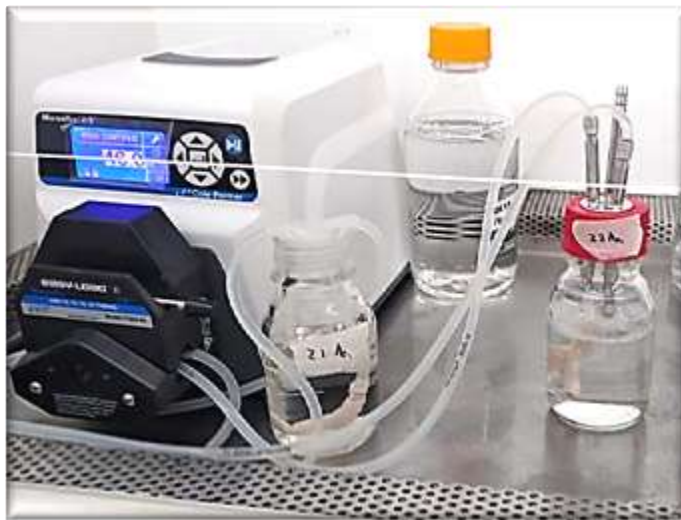
Figura 8. Conexión de la arteria, para el proceso de descelularización.
