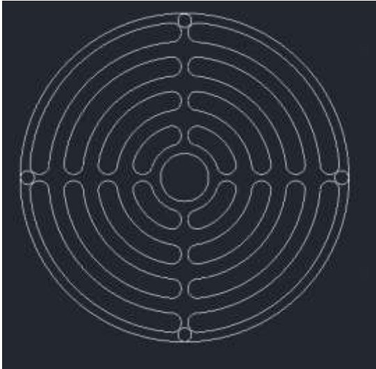
Fig. 16: Diseño 2D de las tapas que irán al inicio y final de los internos del RBT. Diseñado en AutoCAD. Elaboración propia.
