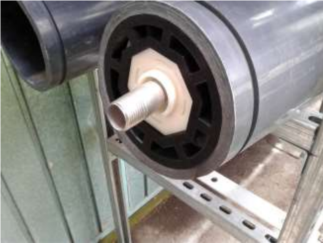
Fig. 29: Prototipo del módulo de aireación al interior del Reactor Biológico Tubular.
