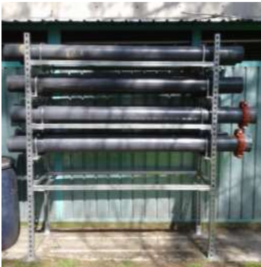
Fig. 25: Estructura principal del Reactor Biológico Tubular RBT.
