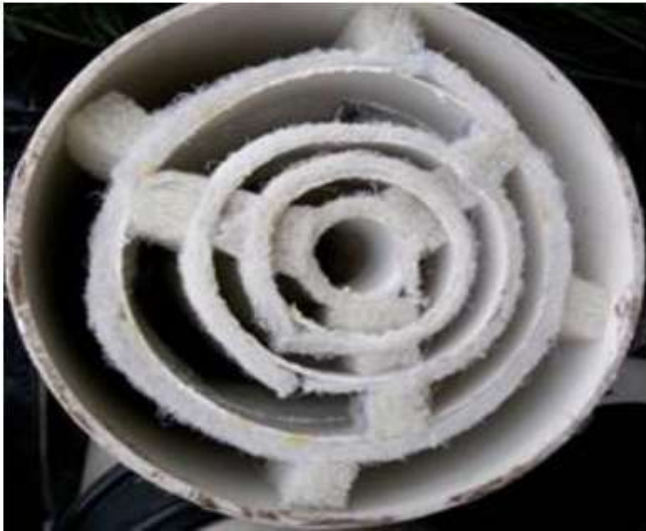
Fig. 4: Fuentes Cuevas A. A. "Estructura de fibra no tejida dentro del reactor tubular de biopelícula", 2017, tesis de licenciatura, p. 60
