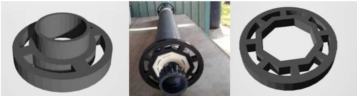
Fig. 19: A la izquierda: Soporte anterior del difusor de aire. Al centro: Difusor con ambas piezas impresas en 3D. A la derecha: Soporte posterior del difusor de aire.
