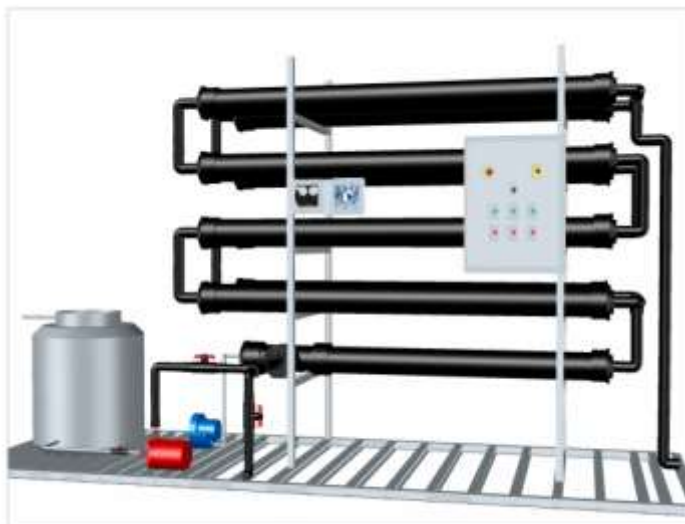
Fig. 18: Modelo del reactor biológico tubular elaborado en AutoCAD. Elaboración propia.
