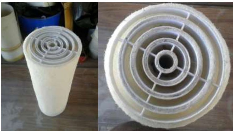
Fig. 23: Modelo "A" con una capa de fibra polimérica añadida al final.
