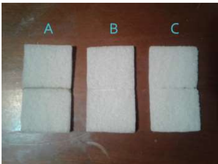
Fig. 21: Pegado de la fibra polimérica. A: pegado con Resistol 5000. B: Pegado con pegamento para PVC marca Siler. C: Pegado con pegamento dorado para PVC marca Omega Pitbull.
