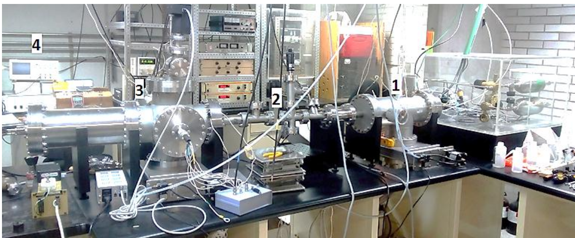
Figura 4.1.1. Acelerador lineal del Taller de Colisiones de la Facultad de Ciencias de la UNAM, 1 Cañón de iones, 2 Línea del acelerador, 3 Cámara de reacción y 4 Zona de detección.
