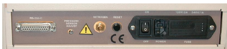
Figura 6.2. Panel trasero del lector TL marca Harshaw modelo 3500 [Th10].
