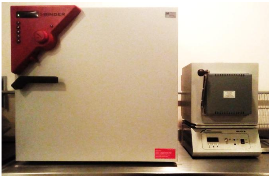
Figura 2.1.1. Hornos del Taller de Física de Radiaciones 1 de la UNAM empleados en el tratamiento térmico de los dosímetros. A la izquierda incubadora microbiológica y mufla eléctrica la derecha.
