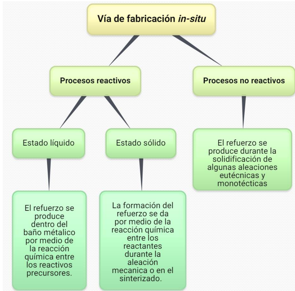
Figura 1.14. Resumen de la vía de fabricación in-situ.
