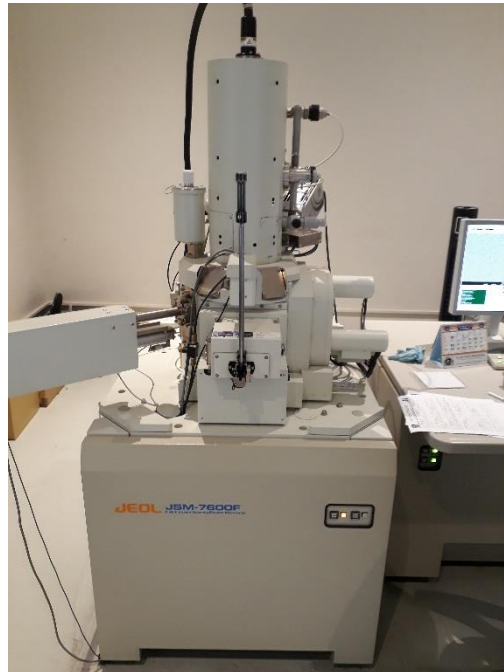
Figura 4.4. MEB JEOL JSM-7600F empleado en la caracterización microestructural.
