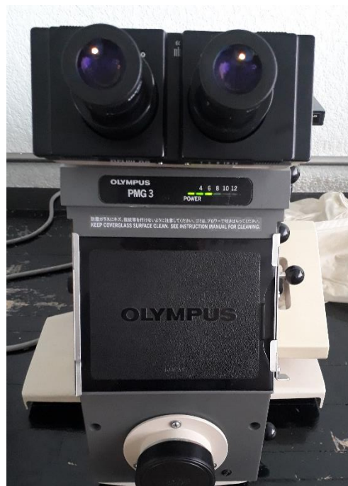
Figura 4.5. Microscopio Óptico Metalográfico OLYMPUS PMG 3 empleado en la caracterización microestructural.
