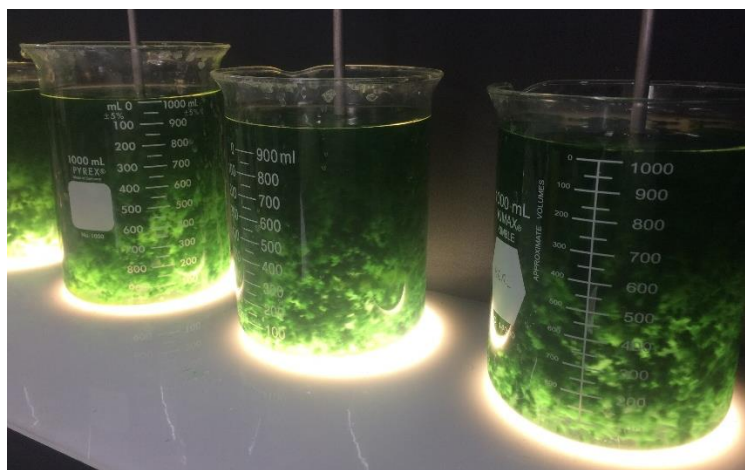
Figura 15. Formación de microfloculos en Prueba de Jarras a distintas dosis de coagulante.
