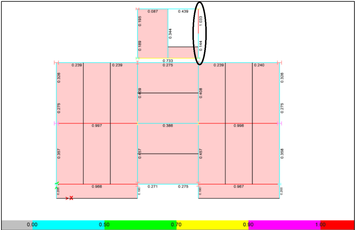
Imagen 5.22.- Vista en planta de los valores de diseño de los elementos estructurales resaltando el seleccionado para el análisis.
