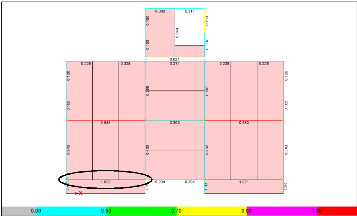
Imagen 5.17.- Vista en planta de los valores de diseño de los elementos estructurales resaltando el seleccionado para el análisis.
