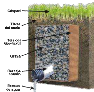
Fig. 6.20. Componentes de un depósito de detención.
