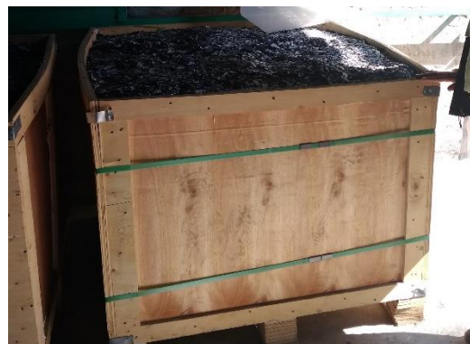
Fig. 9.b: Celdas fracturadas acumuladas
