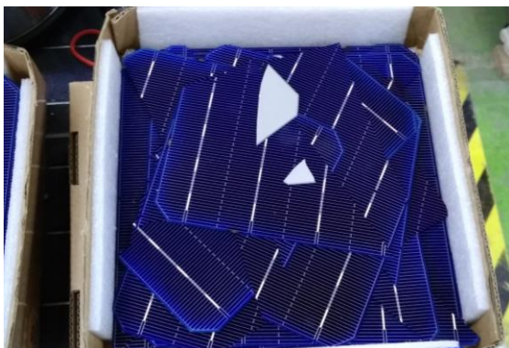
Fig. 9.a: Celdas fracturadas e en proceso
