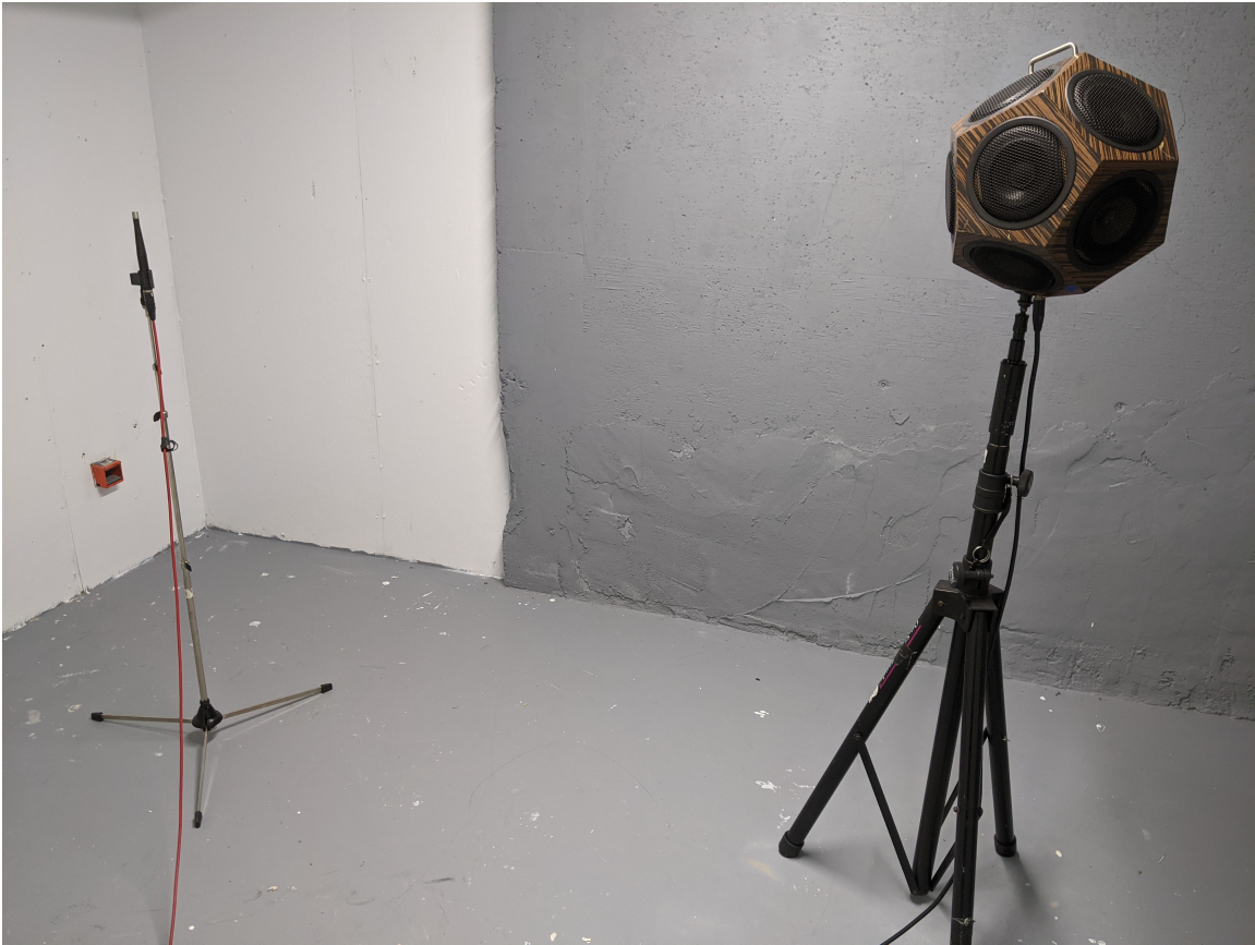
Figura 6.4: Fuente omnidireccional y micrófono de medición utilizados en la medición de las respuestas en frecuencia dentro de la Acousticave en WSDG.
