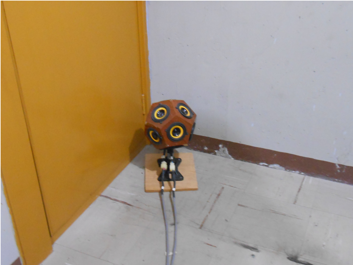
Figura 6.2: Posición de la fuente omnidireccional durante la medición de las respuestas en frecuencia dentro del gabinete alfa en el ICAT. Al colocar la fuente en una esquina se obtiene la máxima generación de modos dentro del recinto.
