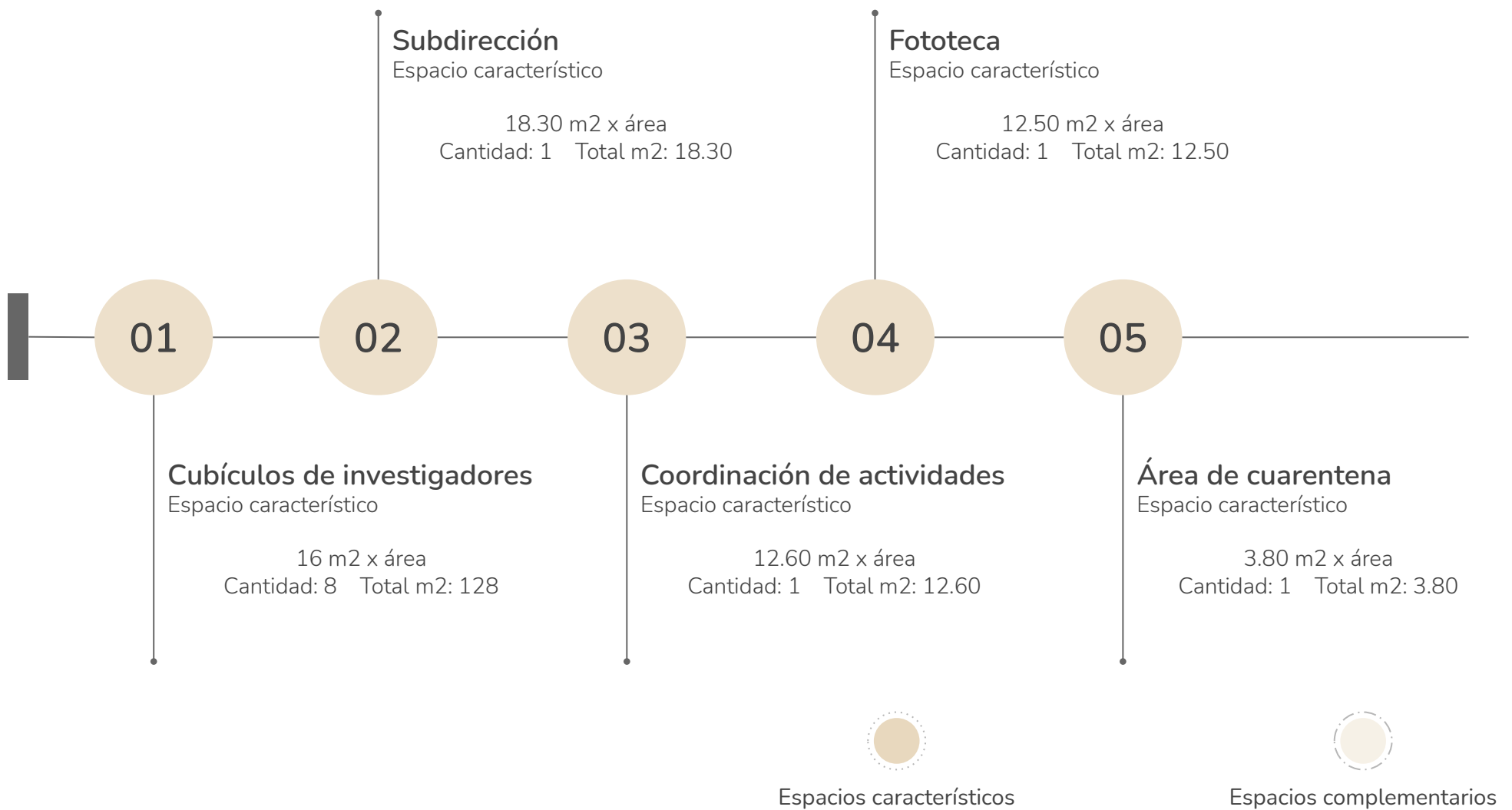
Diagrama 19: Análisis de áreas de los espacios existentes y propuestos para la Subdirección de Etnografía.
