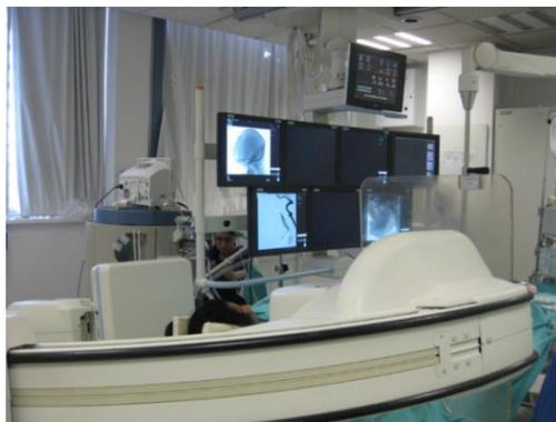
**Figura 11.** Sala de hemodinamia del INNN MVS. Se aprecia un brazo en C (fluoroscópio) que es una pieza del equipo en forma de arco que genera los rayos X para la obtención de imágenes radiológicas en un monitor.
