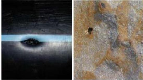
Figura 2.6 a) Perforación en una tubería de polietileno; b) Perforación en una tubería de hierro dúctil.
