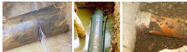
Figura 2.4 a) Rotura circunferencial en una tubería de hierro; b) Rotura longitudinal en una tubería de PVC; c) Rotura en la unión en una tubería de PVC.
