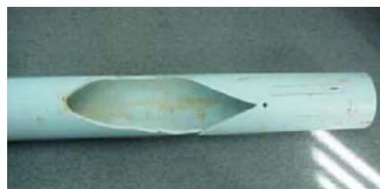
Figura 2.5 Voladura en una tubería de PVC.
