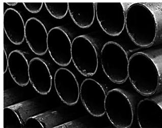
Figura 1.6 Tubería de hierro fundido.
