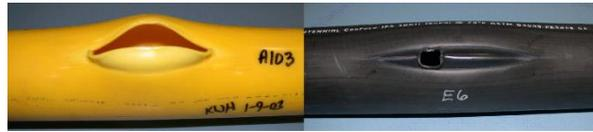
Figura 2.9 Falla dúctil resultado de una prueba. Fuente: Gas Technology Institute. 2009. *Plastic Pipe Failure, Risk, and Threat Analysis*.
