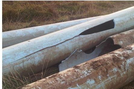
Figura 2.23 Falla de 260 m de longitud por PRF en tubería fusible de PVC de 30" RD25 en Chatham, IL (Palermo, 2010).
