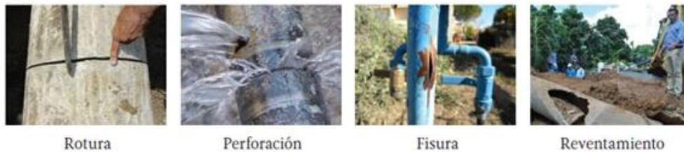
Figura 2.1 Modos de falla en tuberías. Fuente: CONAGUA, Manual de Agua Potable, Alcantarillado y Saneamiento. Libro 42- Mantenimiento y reparación de tuberías y piezas especiales.
