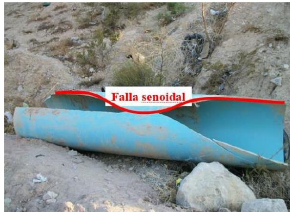
Figura 3.10 Rotura del tipo PRF en un tubo de PVC con presencia de aire atrapado ocurrido en el acueducto Conejos-Médanos en Ciudad Juárez, Chihuahua, México. Fuente: Tolentino K., 2015. Tesis para obtener el grado de Maestra en Ingeniería: Propagación rápida de falla en tuberías plásticas.
