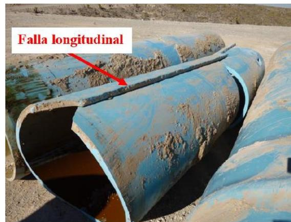
Figura 3.9 Rotura del tipo PRF en un tubo de PVC sin aire atrapado ocurrido en el acueducto Conejos-Médanos en Ciudad Juárez, Chihuahua, México. Fuente: Tolentino K., 2015. Tesis para obtener el grado de Maestra en Ingeniería: Propagación rápida de falla en tuberías plásticas.
