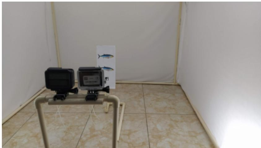
**Fig. 5.3.** Primer montaje en aire que se utilizó. Permitió desarrollar parte de los algoritmos de detección, reconstrucción y la sincronización de los videos.
