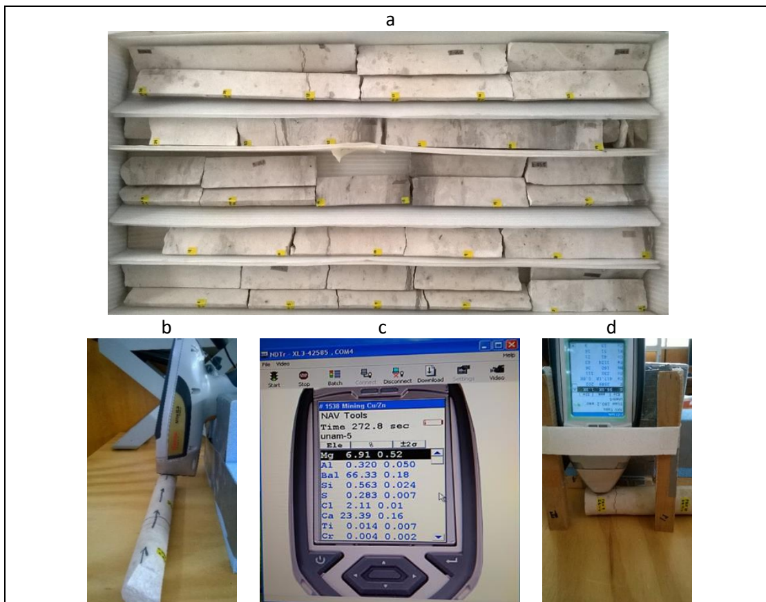
Figura 10. a) marcaje y b, c, d) medición por FRX de 1903 puntos (3806 mediciones) en la etapa 1, con resolución de 10 cm en 202.1 m del registro geológico del Pozo Santa Elena (UNAM-5). La ventana del emisor/detector de FRX se colocó de forma plana en los puntos de muestreo sobre el núcleo. La medición por duplicado se efectuó en el tiempo de máxima eficiencia; siendo en modo “soils” de 180 segundos y en modo
