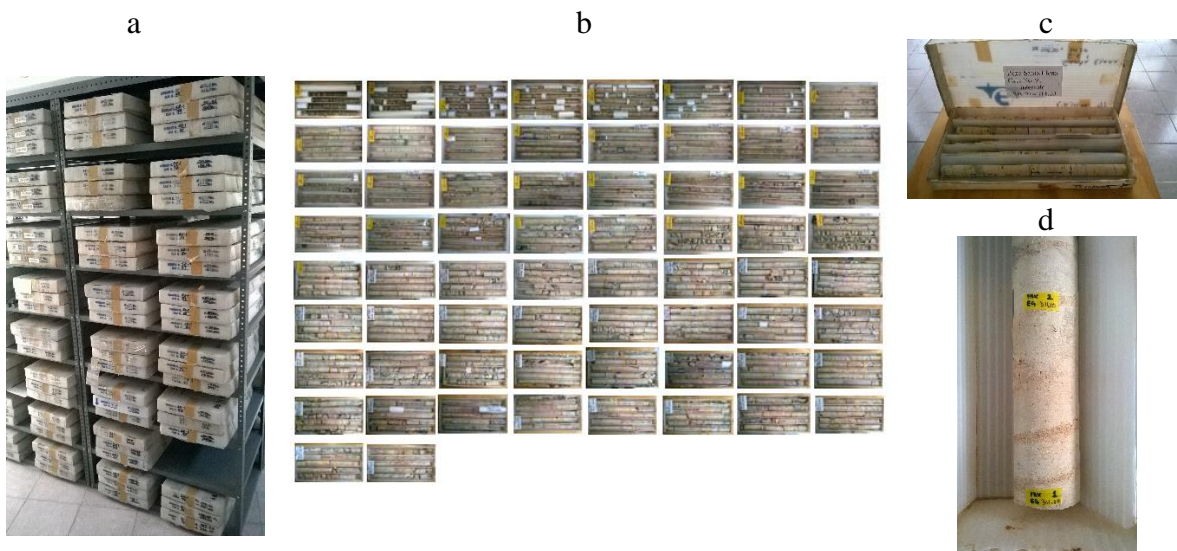
Figura 8. Registro geológico del pozo Santa Elena (UNAM 5). a) resguardo de núcleos geológicos del pozo Santa Elena, dentro del repositorio de la nucleoteca II del Instituto de Geofísica de la UNAM. b) aproximadamente 200 m del registro, en total 64 núcleos. c y d) marcaje de los puntos de muestreo con una resolución inicial de 10 cm.
