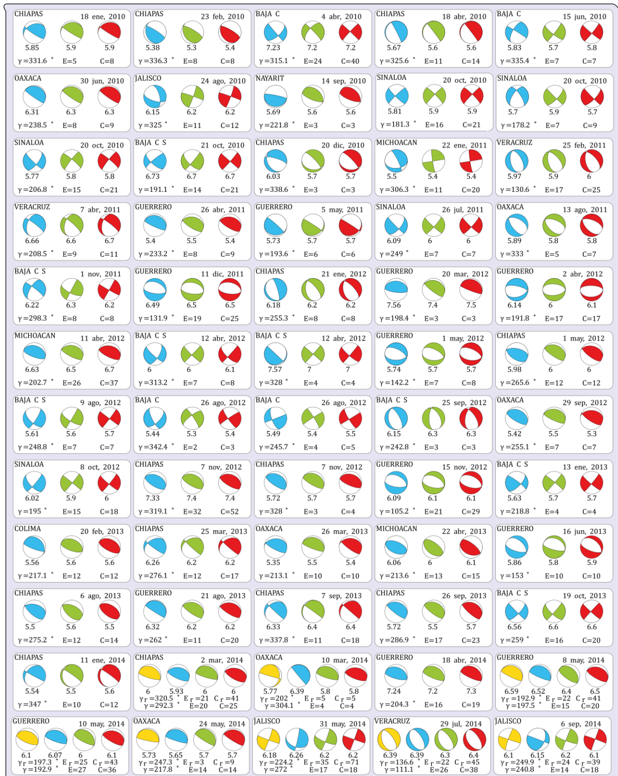
Figura V-2 Comparación de mecanismos focales. En color amarillo se muestra la solución rápida de fase W que obtiene el SSN, en azul, la solución revisada (obtenida en este trabajo) de fase W, en verde, la que reporta el USGS y en rojo, la solución de GCMT. Debajo de cada mecanismo focal se puede ver la magnitud del evento. Los parámetros \gamma , E, C son los que se obtienen de la solución de fase W, representan el valor del gap azimutal, número de estaciones y número de canales, respectivamente. Se añade el subíndice r para representar los parámetros de la solución rápida y poder distinguirlos de la solución revisada.
