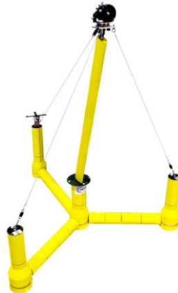
Figura 22. Plataforma semisumergible de peso ligero (Shiohara et al., 2020).
