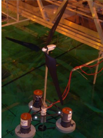
Figura 21. Plataforma semisumergible del proyecto INNWIND.EU (Borisade et al., 2018).
