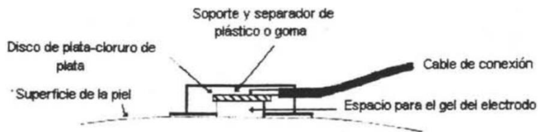
Fig. 7 Configuración interna de un electrodo de superficie. Tomado de García T. Capítulo IV Electrodo. Universidad Autónoma Metropolitana; 2005.
