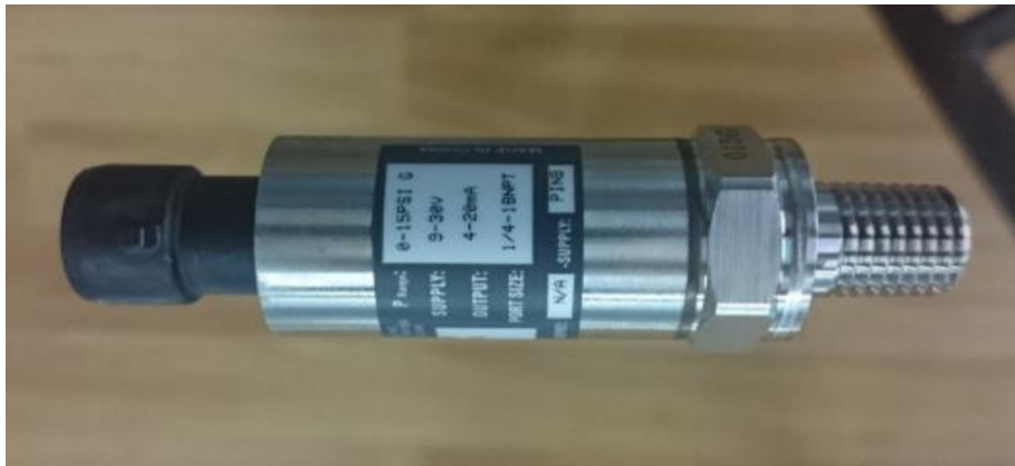
Figura 5.2: Transductor de presión U5300 (Hernández, 2019).
