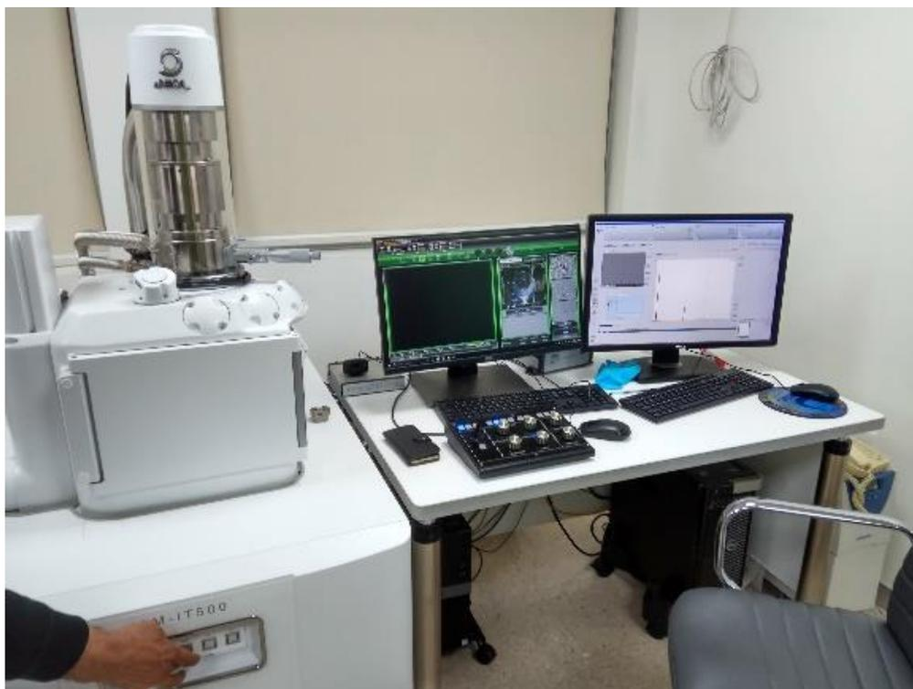
Fig.27 Uso de microscopio electrónico de barrido para el análisis de las muestras de cobre.
