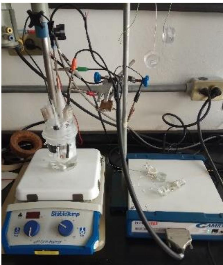
Fig.26 Pruebas electroquímicas realizadas con el equipo de Gamry Interface 1000
