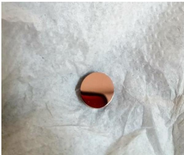
Fig.24. Piezas de cobre lijadas con lija de grano 2000 y pulidas a espejo.
