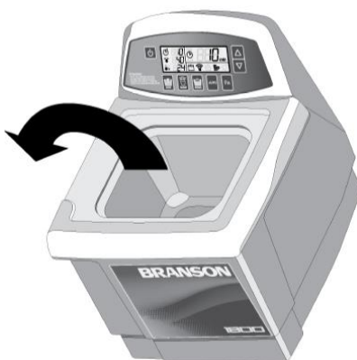
Figura 11 Descripción grafica del vaciado de líquidos, de los modelos 1800 y 2800
