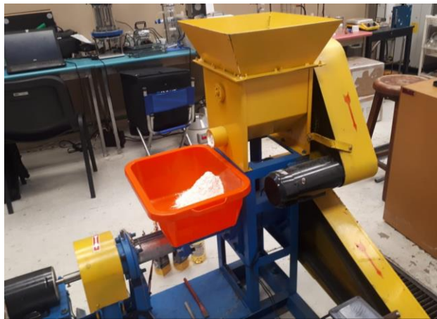
Figura 36. Calibrado de la tolva del extrusor monohusillo Meelko (MKED040C)
