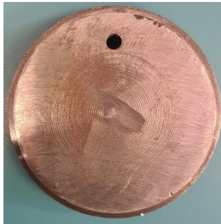
Figura 40. Dado de extrusor monohusillo Meelko con boquilla circular sencilla
