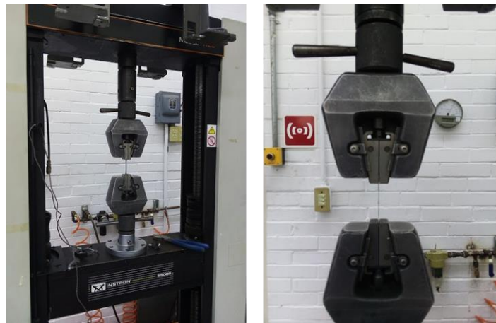
Fig. 21. La primera imagen muestra la máquina de ensayos universales marca Instron, modelo 1125. La segunda imagen muestra una probeta de tensión colocada con las mordazas indicadas para dicho ensayo.
