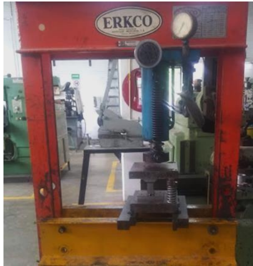
Fig. 20. Sistema (troquel y prensa hidráulica) utilizado para la fabricación de probetas para tensión uniaxial.
