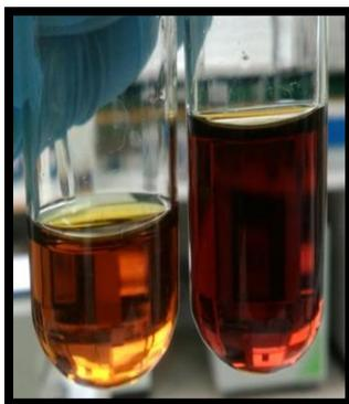
**Figura 32.** Cambio de color en la solución de la F23 en envase de vidrio ámbar a 60°C después de las 24 horas.
