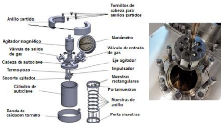
**Figura 2.5** Autoclave para pruebas de corrosión por alta temperatura (Cormet Testings, 2019; Ohio Engineering, 2019).
