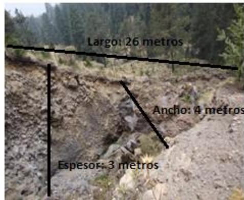
**Figura 58. Cálculo del volumen en campo de un flujo de escombros. Ancho (4 metros), largo (26 metros) y espesor (3 metros): Volumen= 312 m<sup>3</sup>.** Fuente: *Captura propia*
