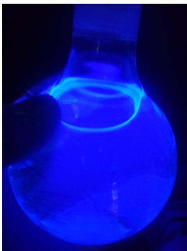
**Figura 4.11)** Matraz con el producto (**R1**) en DCM bajo lámpara de UV de 254 nm
