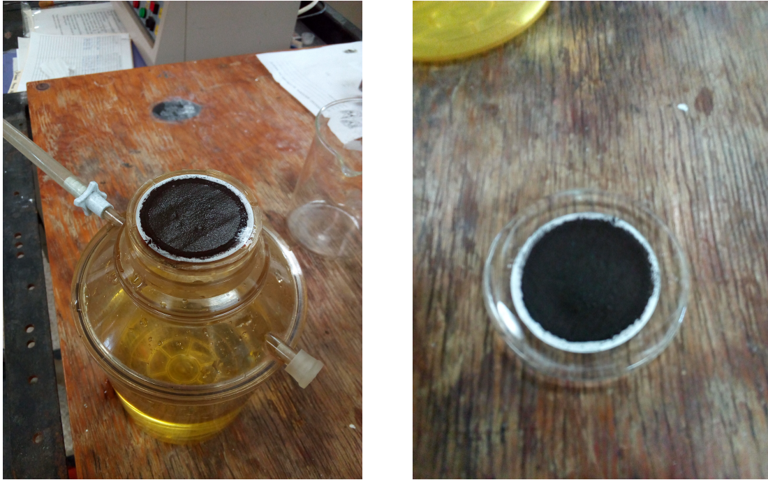
Figura 2.3: Una vez filtrada la sal se deja secar la humedad de la muestra.
