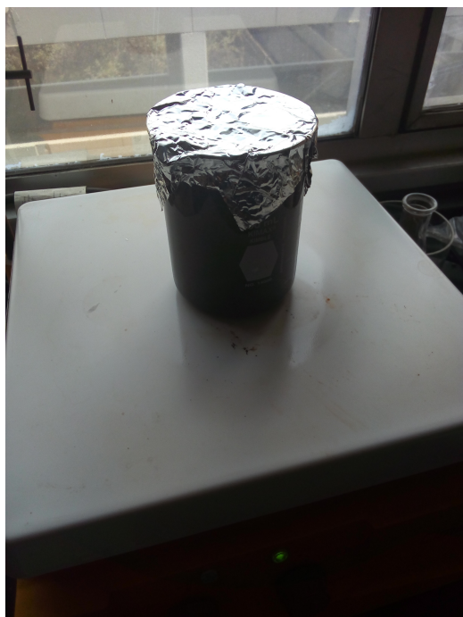
Figura 2.2: Imagen izquierda lavado de la sal en la muestra con agua destilada a 60^{\circ}\text{C} y a la derecha el proceso de filtrado.
