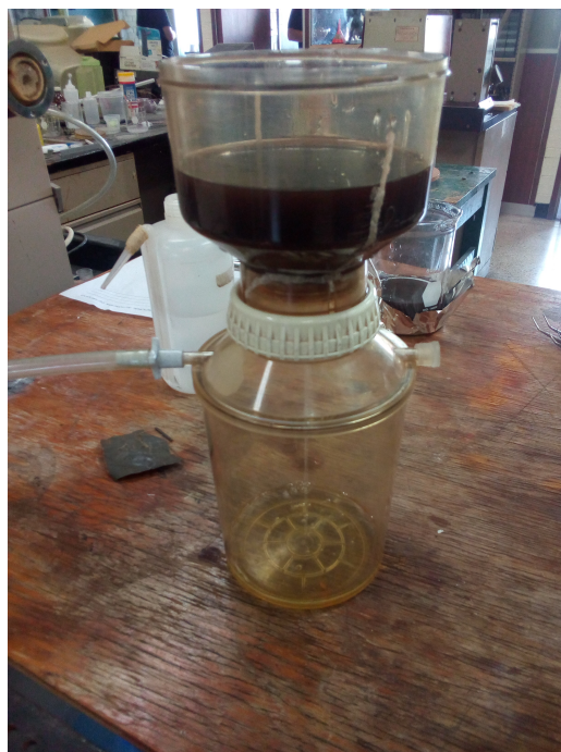
Figura 2.2: Imagen izquierda lavado de la sal en la muestra con agua destilada a 60^{\circ}\text{C} y a la derecha el proceso de filtrado.
