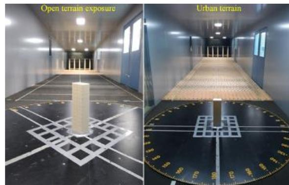
**Figura 2.15** Imagen representativa de modelo rígido en el túnel de viento (Guzmán-Solís, 2020)
