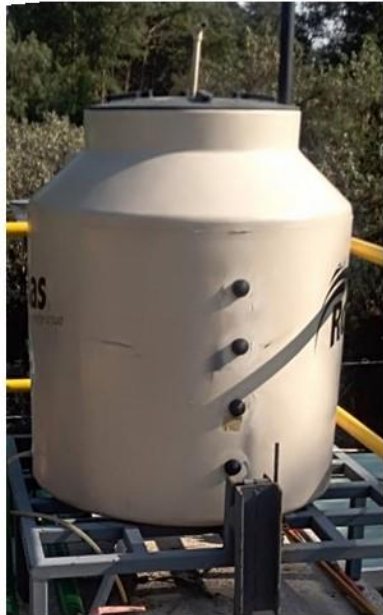
Figura 4.11. Fotografía y corte el recipiente utilizado para la biofiltración del gas desorbido.
