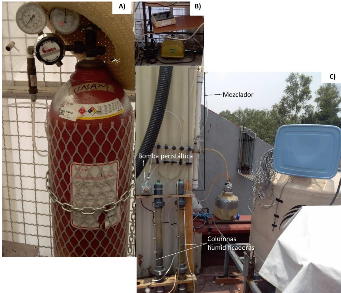
Figura 4.10. Fotografía del sistema de aire y biofiltración de la fase experimental 3. En A) se muestra el tanque de metano al 99.0%; en B) se muestra el compresor de aire y el controlador de la bomba peristáltica; y en C) se muestra las columnas humidificadoras, la bomba peristáltica y el mezclador de gases.
