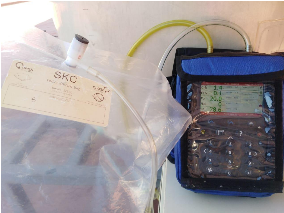
Figura 4.5 Sistema de medición de la mezcla de CH 4 , H 2 S y aire con bolsas Tedlar y el Biogás 5000.
