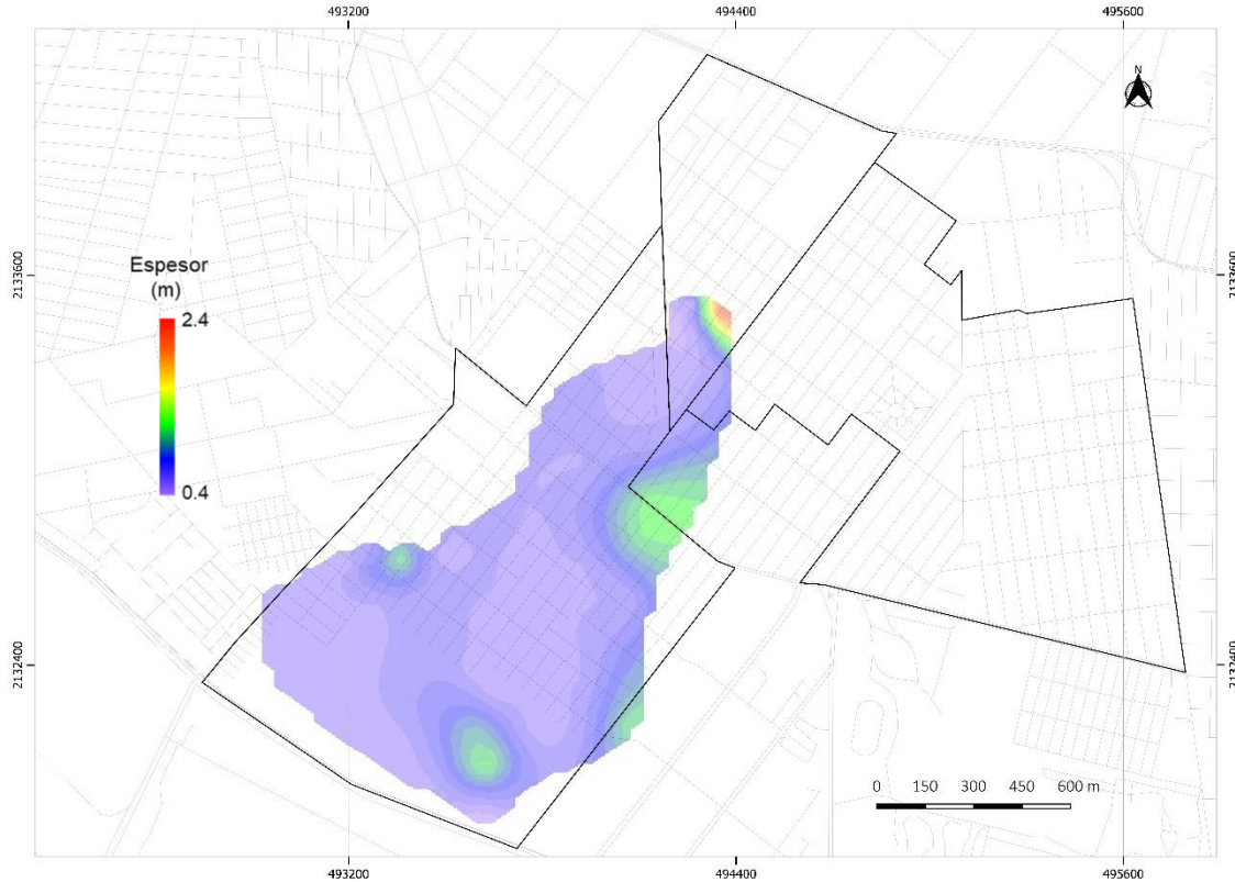
Figura 4.21. Espesor de la inclusión rígida. La mayor parte de la inclusión presenta un espesor de al menos 0.5 m exceptuando algunos puntos muy específicos en los que el espesor alcanza 1.5 m (con permiso de impresión por García et al, 2019).
