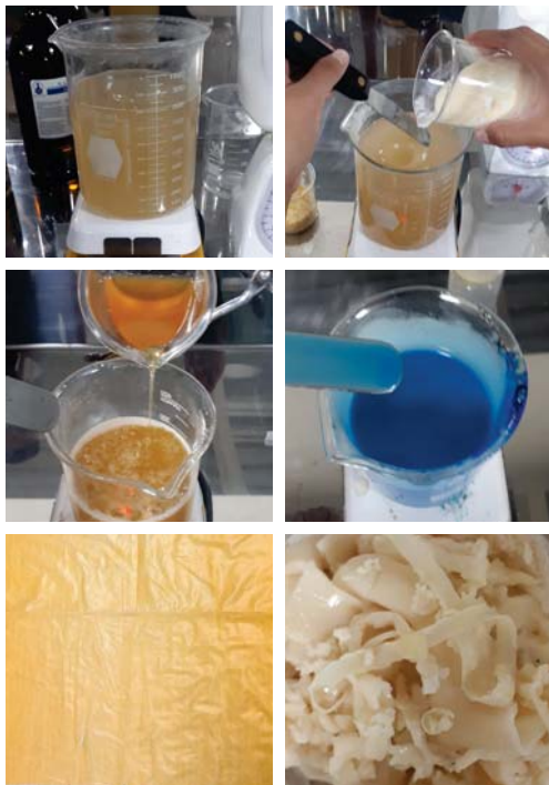
Figura 17. Proceso de fabricación del polímero a base de jugo de nopal en UNIVA. Fuente: elaboración propia.
