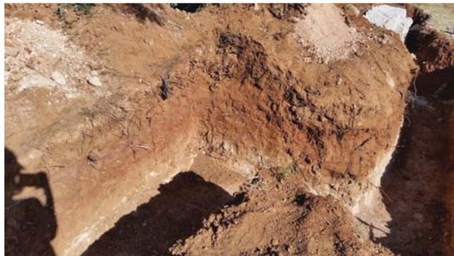
Imagen 77. Perfil de estratigrafía del terreno a 1.5m, con presencia de tepetate.
