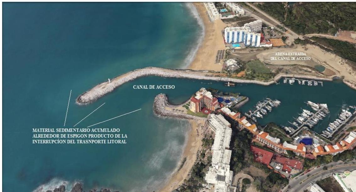
**Figura 26. Canal de acceso a Marina Mazatlán donde se aprecia la acumulación de sedimento alrededor del espigón al parecer mal orientado, en la parte superior derecha se aprecia donde se deposita el material producto del dragado constante para poder mantener el calado apropiado para la entrada de las embarcaciones que atracan en el interior de la marina (Google Earth Pro, 2019).**
