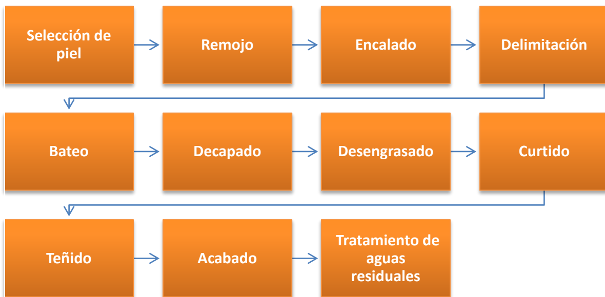
Figura 9. Diagrama que muestra las etapas en el proceso de curtido [9].
