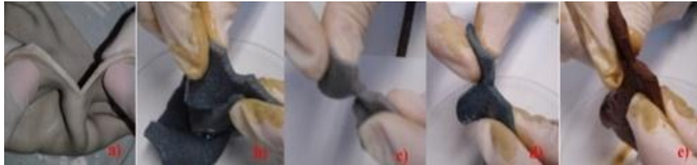
Figura 52. Curtido utilizando sales de cromo recuperadas de pruebas (en el proceso de separación del cromo): a) piel antes del proceso de curtido; b) PQ (Precipitación química); c) EC Al-Al; d) EC Cu-Cu; e) EC Fe-Fe [2].
